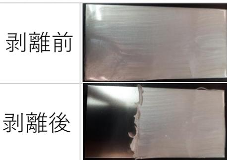
剥離前は金属板全体に塗料が塗布されていましたが、金属板を R-4260 へ半浸漬し超音波を照射しながら剥離をしたところ、浸漬部分は綺麗に塗料が剥離できました。
